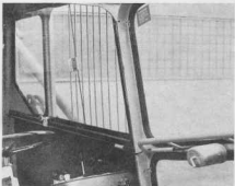
Bilden ovan visar anordningar för öppning och låsning av sidofönster samt säkerhetsanordning för att avlägsna rutor ur dörren när denna blockerats.
